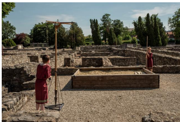
8. ábra Egyenes kitűzése egy ókori földmérő eszköz (groma) másolatával
